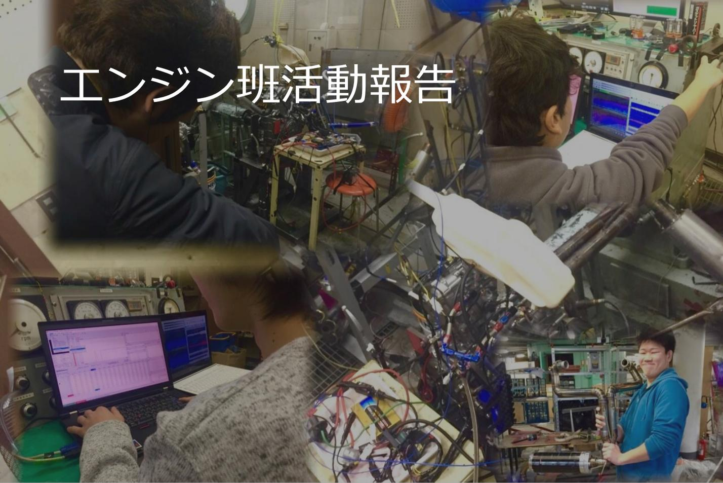
1月に始動確認いたしました新ピストン、新シリンダーを搭載した693.8ccのv型2気筒エンジンを用いて2,3月の春休み期間はエンジンベンチによるカムシャフトの選定、吸排気管長の最適化、スロットル径の小径化の検討など様々な実験を行いました。
